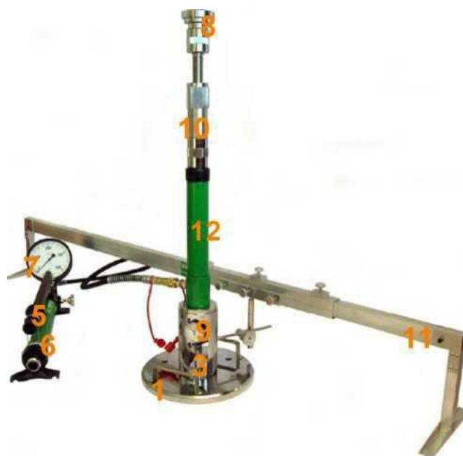
Rys. 1.2 Aparatura VSS z jednopunktowym pomiarem przemieszczenia płyty
