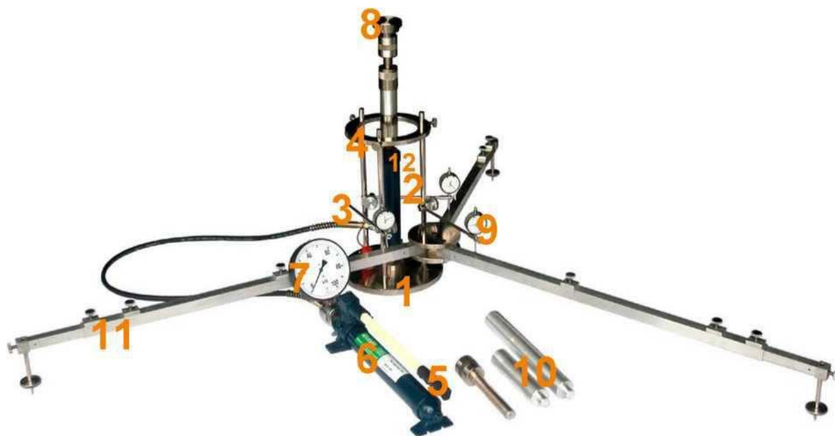
Rys. 1.1. Aparatura VSS z trzypunktowym pomiarem przemieszczenia płyty
